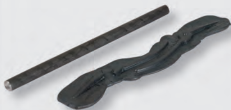
Kucie elementu nieobrobionego szczypiec
