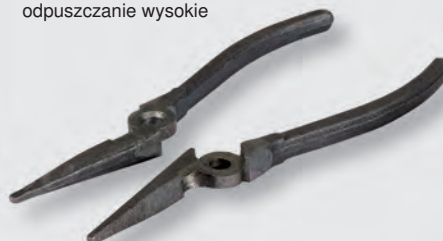
Hartowanie i odpuszczanie wysokie
