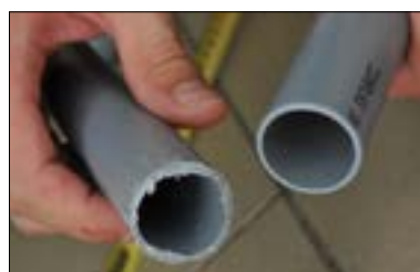
Cięcie piłką do metalu (po lewej) i narzędziem P-TEC 3240 (po prawej).
