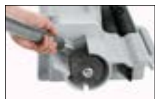
Opcjonalna tarcza do usuwania zadziorów wykorzystywana jest do szlifowania krawędzi zewnętrznych w celu ułatwienia szczelnego łączenia.
