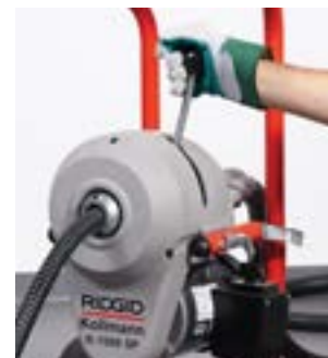
Po zwolnieniu uchwytu sprężyna natychmiast się zatrzymuje
