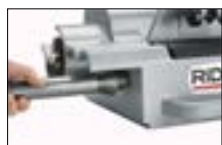
Za pomocą rozwiertaka wewnętrznego można szybko i łatwo usuwać zadziory powodujące zawirowania przepływu.
