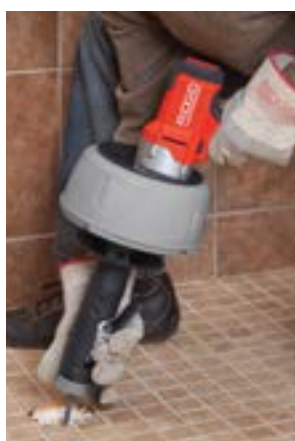
Sprężyna 3/8" (10 mm) w modelu K-45AF-5 rozszerza możliwości maszyny na linie odpływowe 2 1/2" (75 mm).
