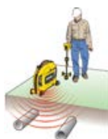
Wzbudź sygnał, aby zlokalizować uzbrojenie.
