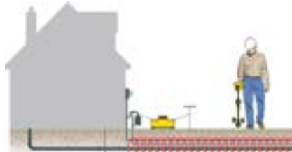
Połącz bezpośrednio z przewodami uzbrojenia.
