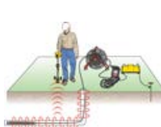
Znajdź plastikową rurę za pomocą integralnego śledzenia przewodu.
