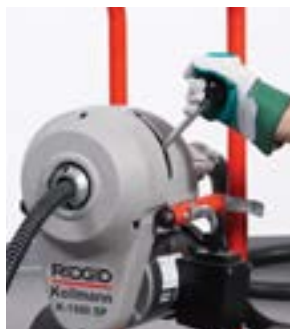
Po załączeniu sprzęgła sprężyna obraca się
